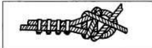
Брамшкотовый. Стыкование наглухо концов стальных канатов.
