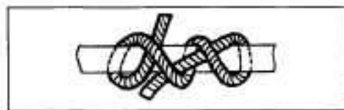
Задвижной штык. Крепление каната к стержням (трубам, мачтам, якорям).
