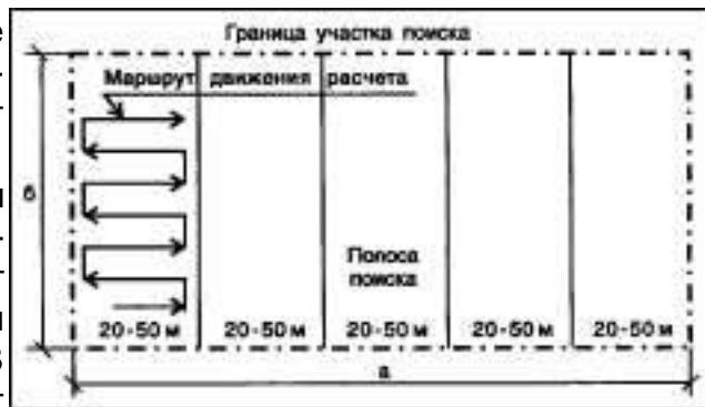
Схема сплошного визуального обследования участка спасательных работ
