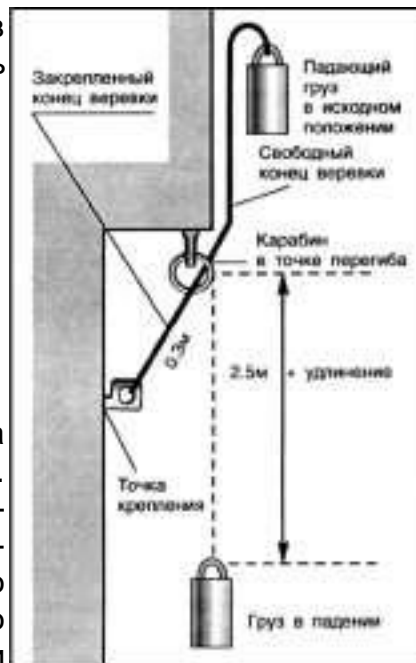
Схема испытания веревки
