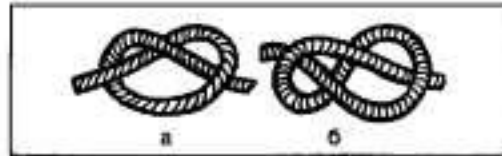
Раскрепительный: а — для одного элемента; б — для двух элементов. Раскрепление элементов пеньковыми и капроновыми канатами
