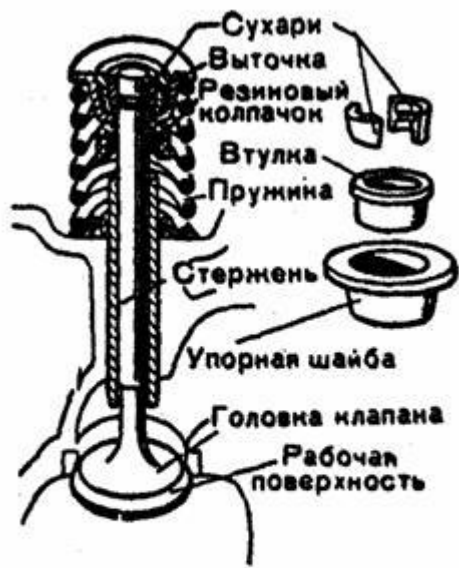
Рис. 66. Клапан, пружина и ее крепление.
