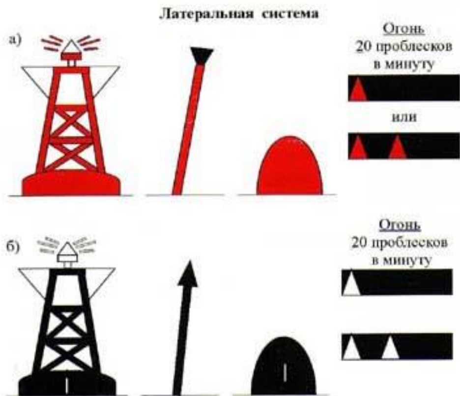
Рис. 230. Плавающие знаки ограждения сторон каналов и фарватеров: а) левой стороны; б) правой стороны.
