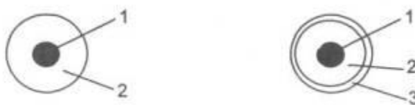
Рис. П. 1.33. Одножильные, однопроволочные провода круглого сечения: 1 - жила (медная, алюминиевая, алюмомедная); 2 - изоляция (резина, ПВХ); 3 - оплетка (хлопчатобумажная пряжа) или оболочка (ПВХ)
