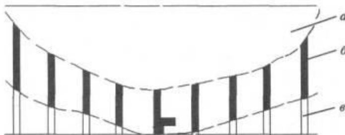
Рис. 4.5. Выгорание деревянных перегородок в помещении (по мере удаления от очага, термические поражения, последовательно затухающие):
